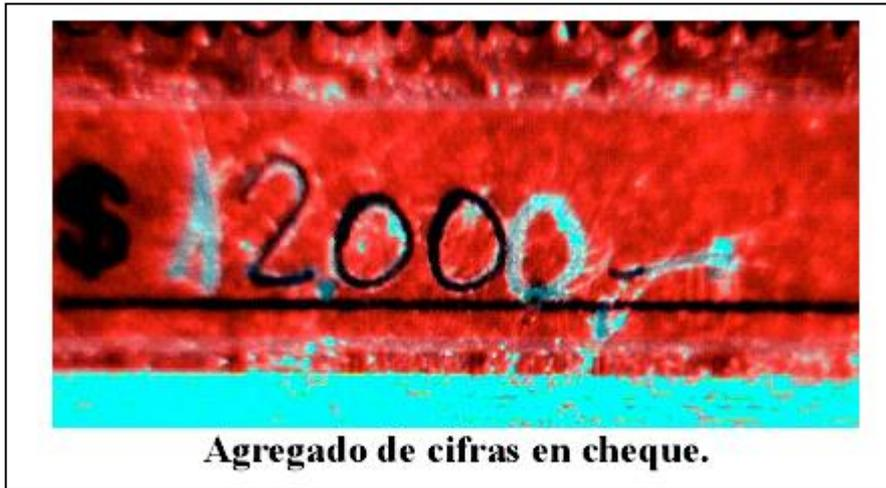
c) Tachaduras: es posible, gracias a la penetración del infrarrojo sobre los soportes celulósicos, registrar escrituras tachadas o efectuadas en distintos tiempos por distintas tintas.
